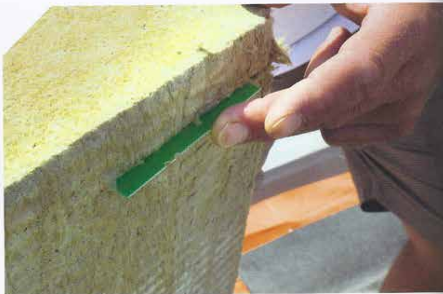
▲ Die Sensoren werden einfach in die Dämmung gesteckt; ein Sensor deckt dabei rund 4 m 2 ab
